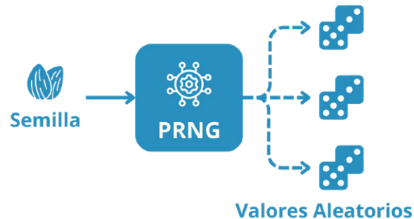
Figura 1. Descripción gráfica del funcionamiento de un generador pseudoaleatorio PRNG ( pseudorandom number generator ).
